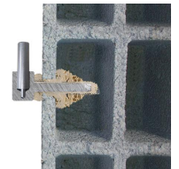
Filtere métallique - vue en coupe
