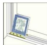
3. Appliquer le liant sur les surfaces de contact de la brique avec la bande verticale. Étendre le liant en un fin cordon d'environ 5 mm, de manière régulière et sans discontinuité sur les parties plates en PVC, sur les ergots mâles et les rainures.
